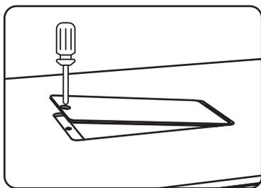
2、拉开 SSD 固定卡扣将准备好的硬盘插入接口，按压卡扣固定好 SSD，再装回硬盘盖板和螺丝即可。
